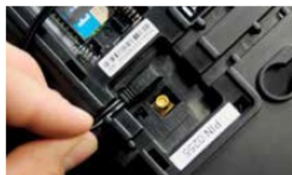
Mrežni priključak i SIM kartica su iza čvrsto zatvorenog poklopca dobro zaštićeni od sabotaze.
