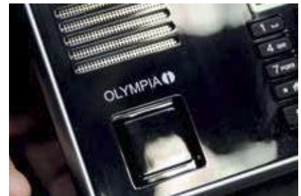
Sirene und Freisprecheinrichtung bzw. Mikrofon an der Alarmzentrale.
